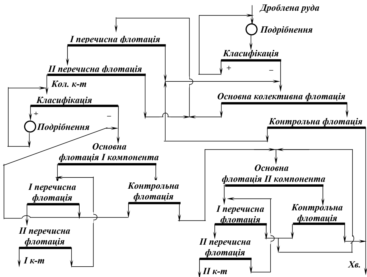
Рис. 4.6. Схема флотації двокомпонентної руди.
