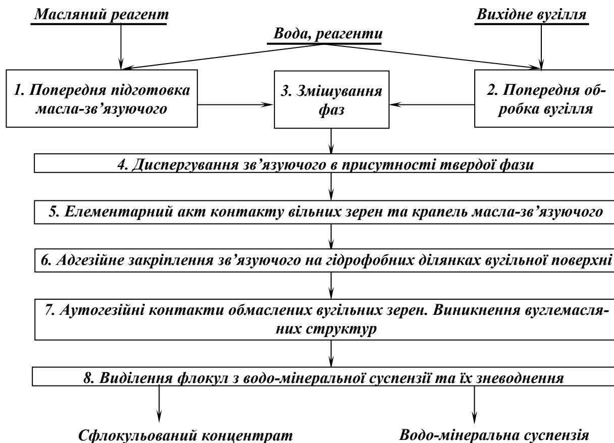
Рис. 7.3. Феноменологічна модель процесу масляної флокуляції.
