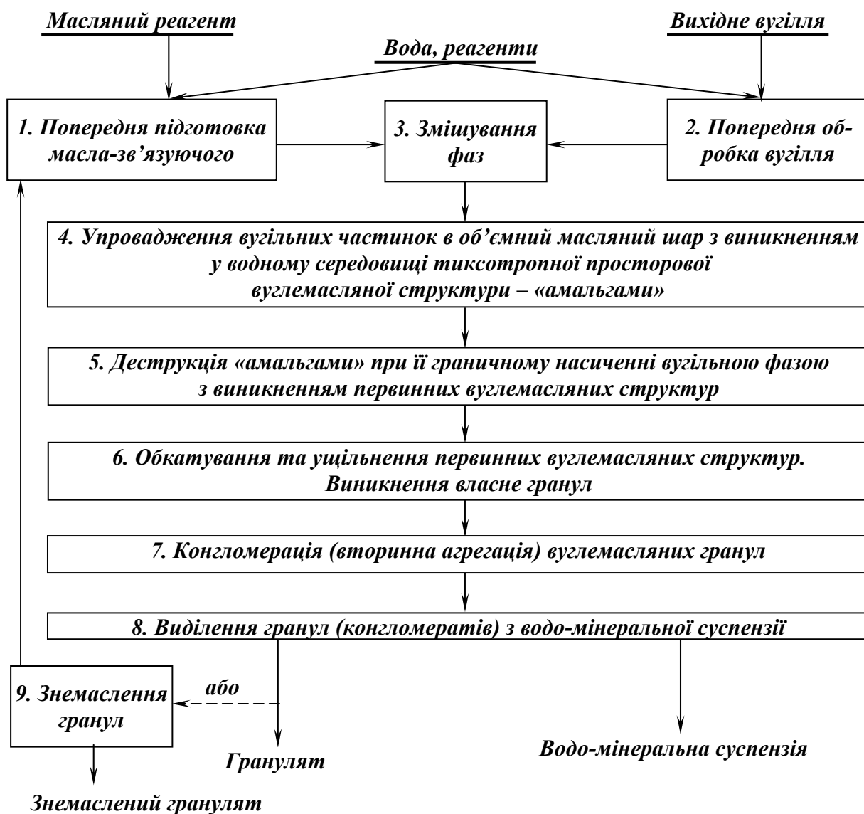
Рис. 7.1. Феноменологічна модель процесу масляної грануляції за «амальгамним» механізмом.
